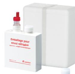
Le container contient un liquide réfrigérant. Il doit être congelé à -20°C (sans le polystyrène) minimum 24h avant l'envoi. Le froid emmagasiné pourra ensuite maintenir une température inférieure à 10°C durant 16 heures.
